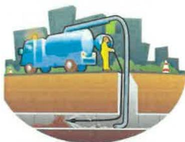
Nous avons procédé au curage du réseau de collecte des eaux pluviales afin de supprimer les obstructions et maintenir un écoulement constant.
